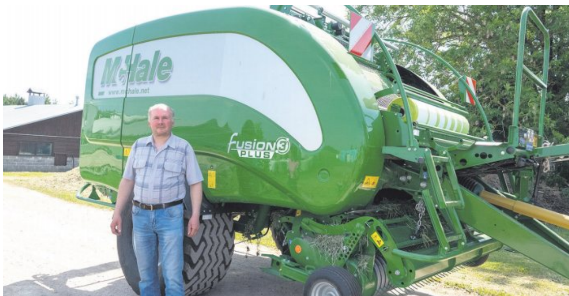
McHale kombipress on talus alles mõned päevad tööd teinud. Masin tõmbab kokkurullitud rohule võrgu ümber ja tagumises kambris algab kiletusprotsess.
