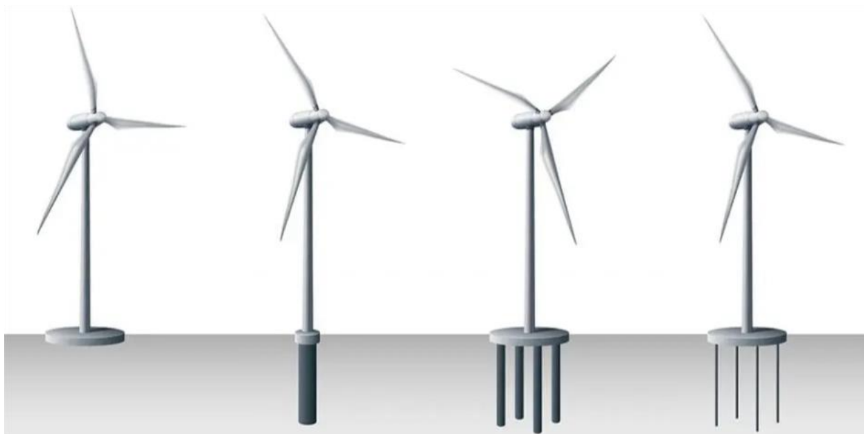
Joonis 2. Tuulikute vundamentide tüübid 6 . Vasakult gravitatsioonivundament, ühevaialine vaivundament ehk monovaivundament, plaatvundament kombineeritud vaiadega, plaatvundament kombineeritud ankrutega.
