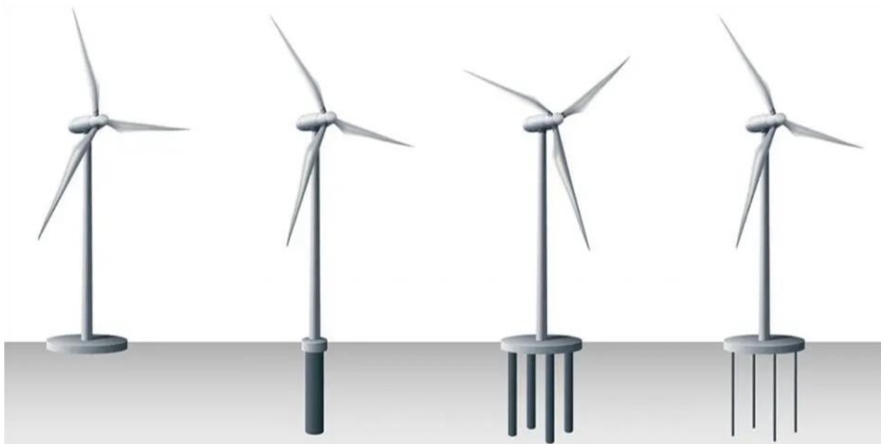
Joonis 2. Tuulikute vundamentide tüübid 5 .
